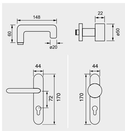
FERRO - SPINDLE  $\varnothing$  9
