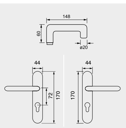
FERRO - SPINDLE  $\varnothing$  9
